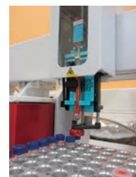
Slika 2. Zaznavanje aktivnih sestavin prek GC-MS/GC-FID na centru za raziskave BIOMIN Research Center, Tulln
